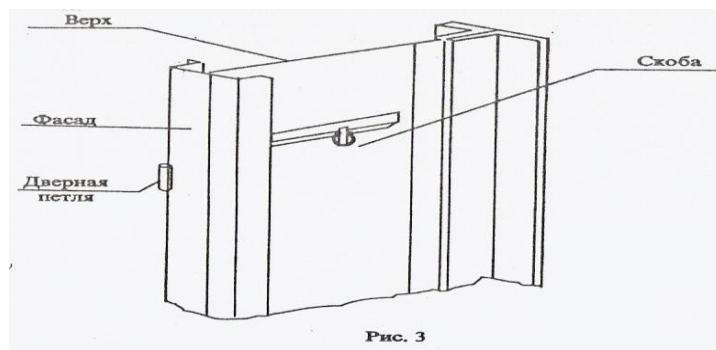
**Задняя стенка** (3 шт.). В верхней части имеет деталь для крепления к ней крышки, а по бокам - отгибы для соединения с боковыми стенками и перегородками (рис. 4).
