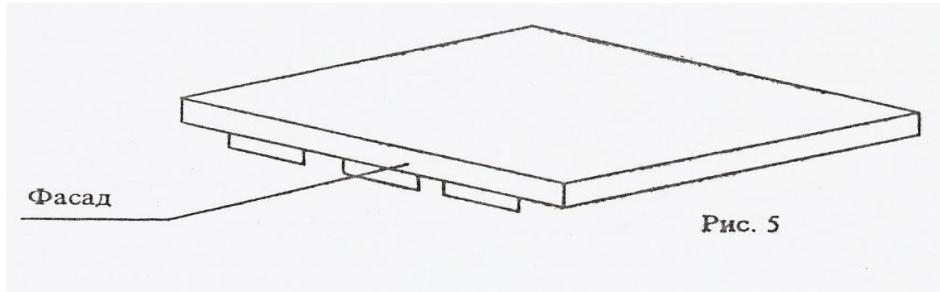
**Фасадная панель.** (3 шт.) соединяет между собой боковые стенки и перегородки. Устанавливается в нижней части шкафа (рис. 6).
