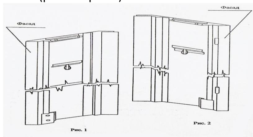
**Перегородка (2 шт.).** На фасадном торце имеет петли для навески дверей. В верхней части расположена скоба для установки перекладины и полки (рис. 3).
