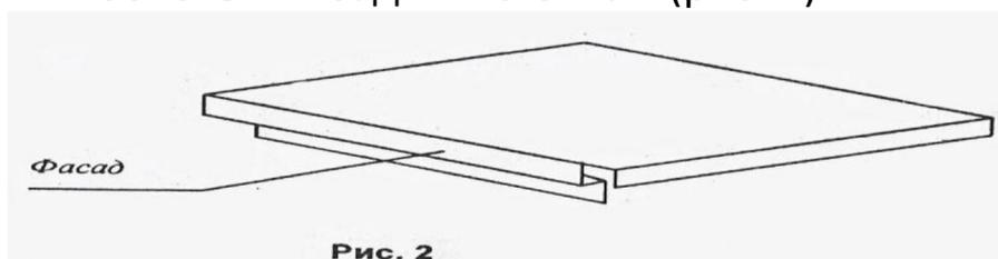
**Полки шкафа.** На нижней поверхности имеют усилитель и два уголка, входящие в захваты в боковых стенках (рис.3)
