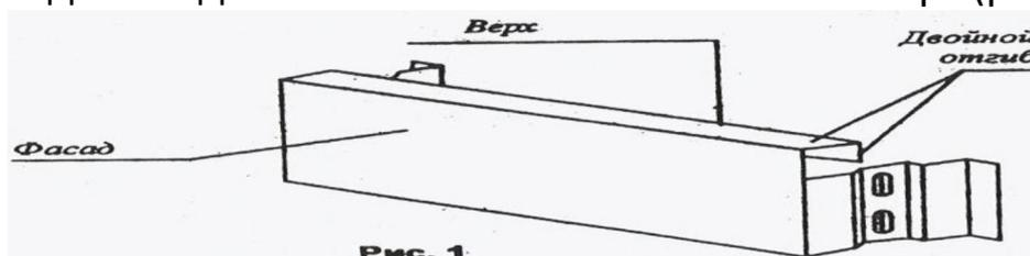
**Крышка шкафа.** На внутренней поверхности крышки с трех сторон располагаются 4 детали с восемью продолговатыми отверстиями для крепления к боковым и задним стенкам (рис. 2)
