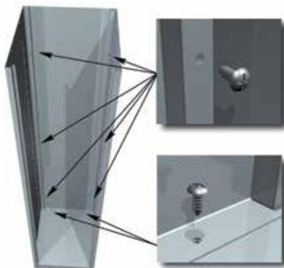
Установить правую заднюю стенку , соединив ее с правой боковой стенкой с помощью трех саморезов , с левой задней стенкой – спомощью трех саморезов и с дном – с помощью двух саморезов.
