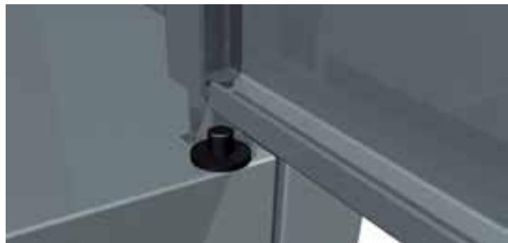
11. «Утопив» подпружиненный металлический наконечник верхней оси, завести дверь под верхнюю ось и совместить соответствующее отверстие в двери с осью до выщелкивания наконечника.
