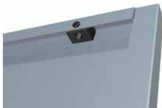
13. Установить замок в открытое положение, повернув ручку против часовой стрелки до упора. В таком положении вставить замок язычком вверх в соответствующее отверстие двери до защелкивания фиксаторов.
