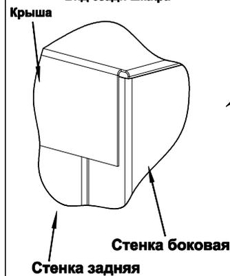
1. Установить локер вертикально . Установить крышу, и отогнуть язычки.
